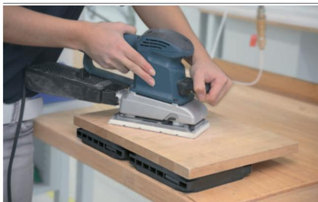
Multi-Clamp piastra di aspirazione VC-M-SP per la lavorazione manuale di un pezzo di legno
