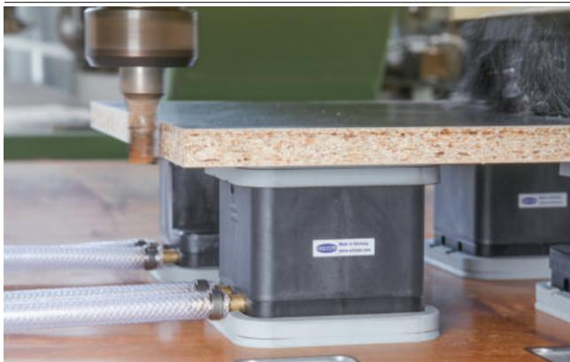
Blocchi di aspirazione VCBL-G-K2 durante il bloccaggio di pannelli in truciolato
