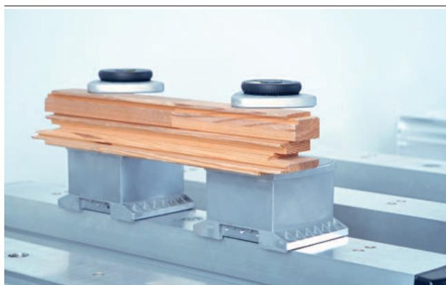
Bloccaggio meccanico VCMC-K2-QUICK per il bloccaggio di parti del telaio
