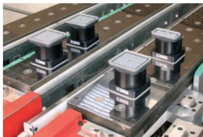
Steel-Plate Innospann montata su un piano di lavoro a barre
