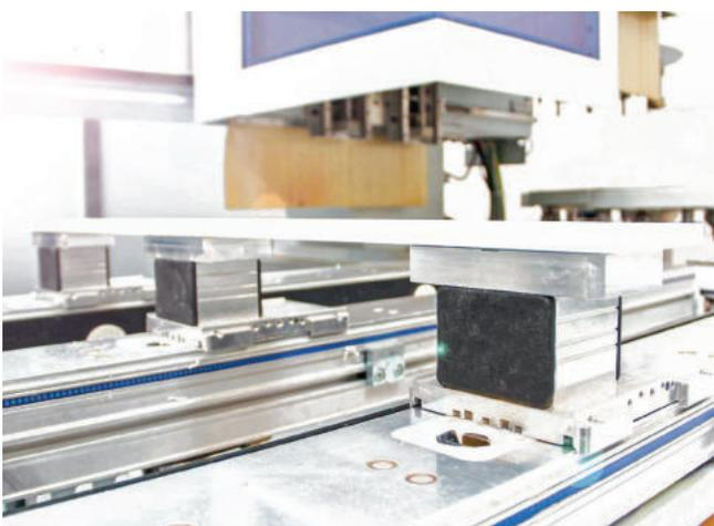
Blocco di aspirazione VCBL-A-K2 in alluminio per la lavorazione dei componenti per i mobili
