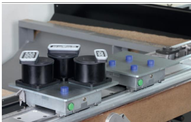
Adapter-Plates ISAP-B con Mono-Base e ventose per il fissaggio di componenti di legno
