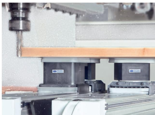
Blocco di aspirazione VCBL-K2 per la lavorazione dei pannelli di legno
