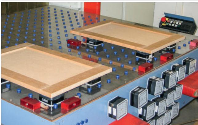
Innospann Steel-Plate con Mono-Base e ventose cup
