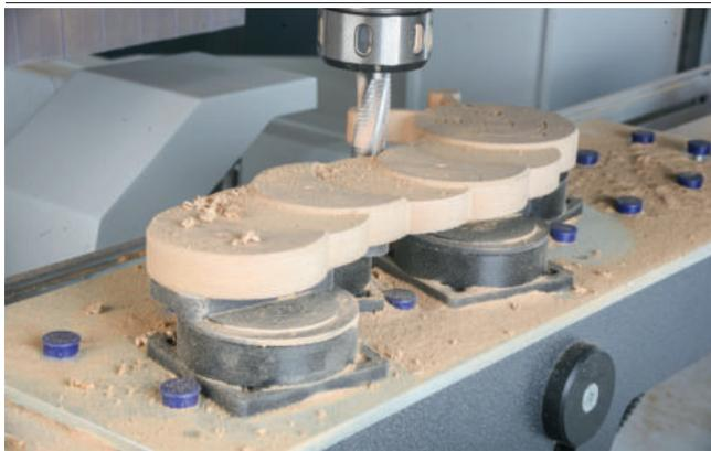
Adapter-Plates ISAP-K1 con Mono-Base e ventose per il fissaggio di pezzi di legno curvi
