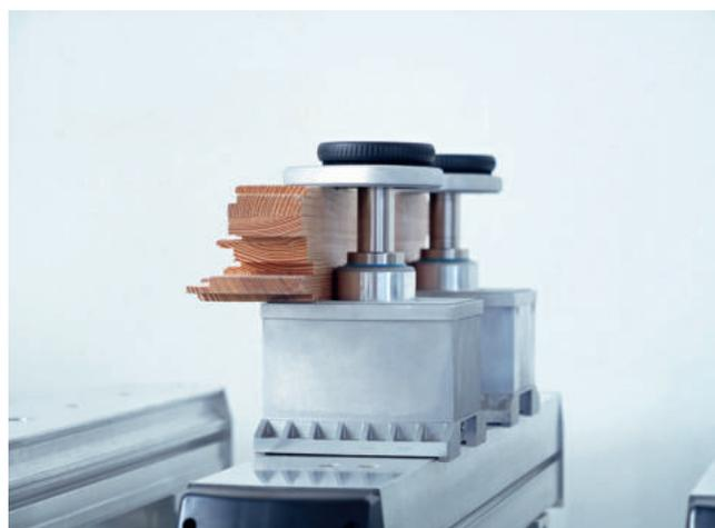
Bloccaggio meccanico VCMC-K1 per la lavorazione di componenti per telai sottili
