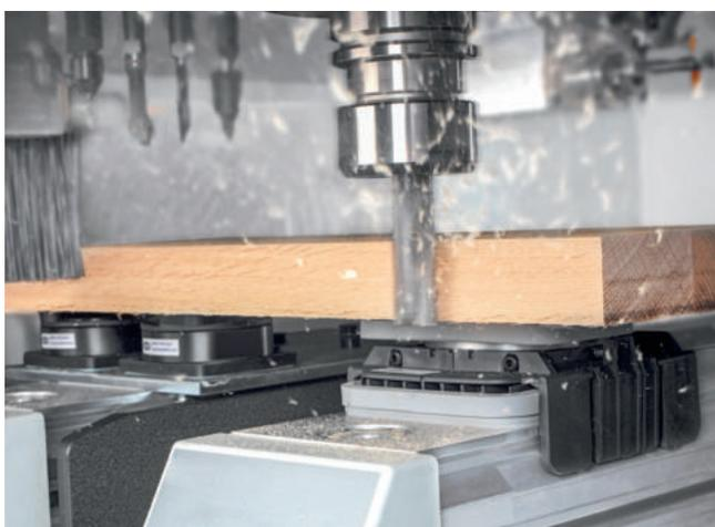
Blocco di aspirazione VCBL-K1 per funzionamento misto con Adapter-Plate ISAP-K1 per la lavorazione dei pannelli di legno
