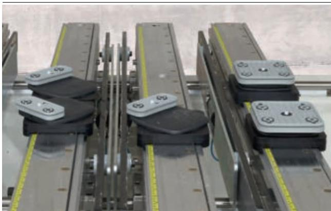
Adapter-Plate AP-S4 con ventosas de bloque VCBL-B para fijar piezas de madera con diferentes geometrías
