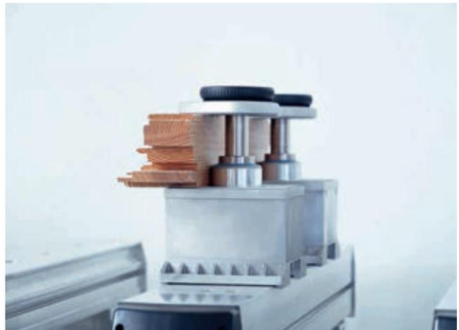
Fijación mecánica VCMC-K1 durante el mecanizado de piezas de marco delgadas
