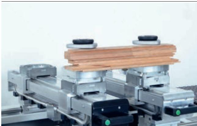
Fijación mecánica VCMC-B-QUICK fijando marcos
