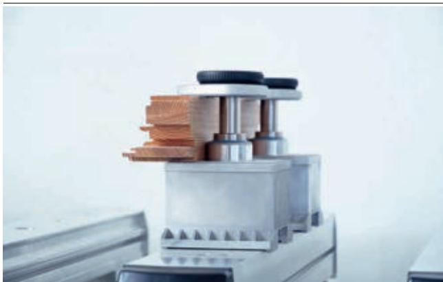
Fijación mecánica VCMC-K1-QUICK fijando marcos
