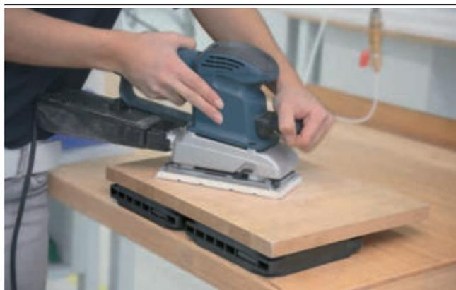
Multi-Clamp placa de ventosa VC-M-SP en el mecanizado manual de una pieza de madera
