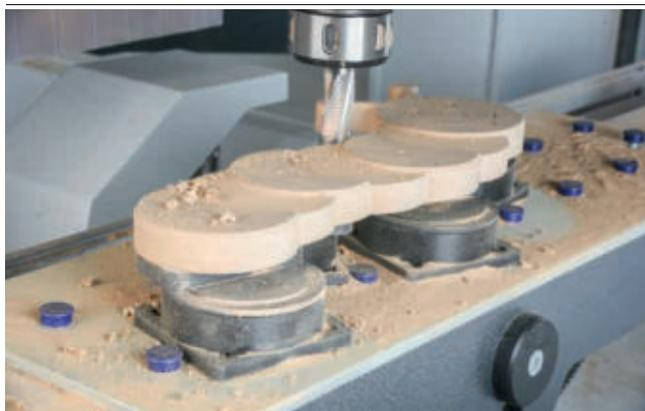
Adapter-Plates ISAP-K1 con Mono-Base y ventosas fijando piezas de madera curvadas
