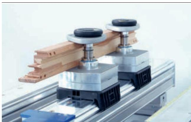
Fijación mecánica VCMC-S4-QUICK fijando marcos
