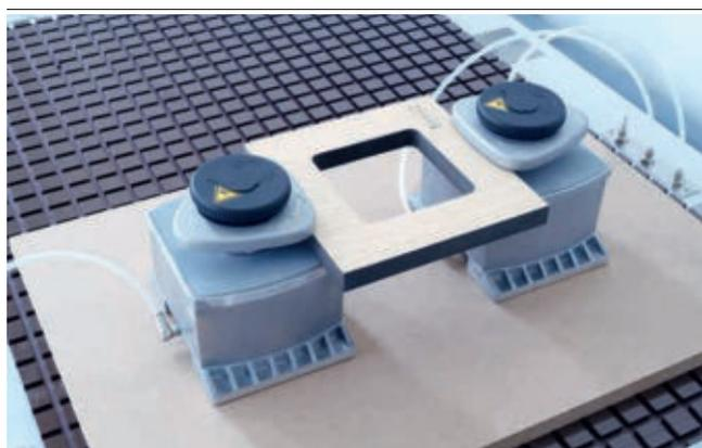
Fijación mecánica VCMC-G-QUICK fijando marcos
