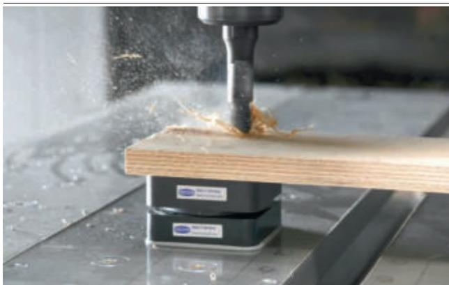
Innospann Cup y Base fijando una pieza de madera
