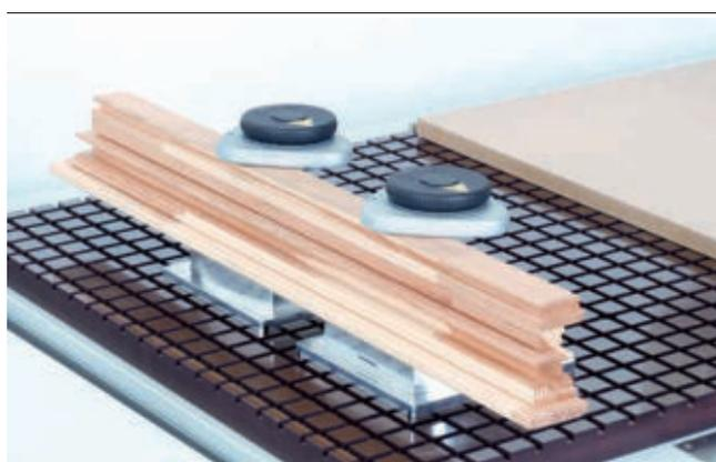
Fijación mecánica VCMC-R-QUICK fijando marcos
