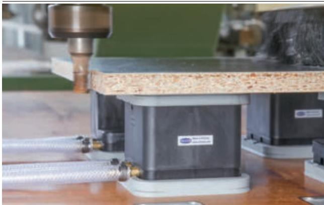
Ventosa de bloque VCBL-G-K2 fijando un tablero de madera aglomerada
