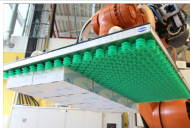
SPB2-P/パッドに組み込まれたスロットルバルブによって、ワークがグリッパ全面を覆わなくても真空圧を維持する事が可能
