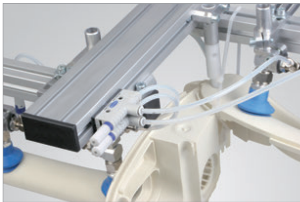
マークレスゴム製 FSGA/パッドによるカーブした樹脂成形品の吸着
