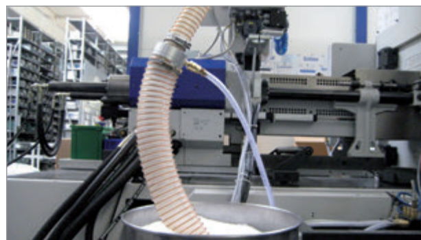
大吸込量エジェクタ SEC を使用したプラスチックペレットの搬送
