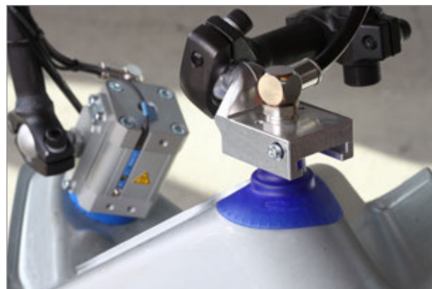
成形された金属部品の凸部分を吸着するSAXM/パッド
