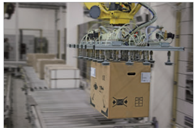
複数の FSGA/パッドを使用した段ボール箱の搬送
