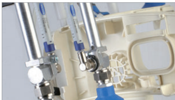
射出成形後の樹脂/パーツの搬送に使用されるインラインエジェクタ
