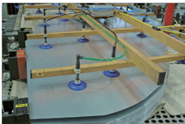
スプリングプランジャー FSTI によって吸着時の衝撃を吸収
