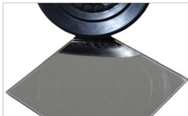
一般的に使用されることの多いニトリルゴム製パッドの吸着跡
