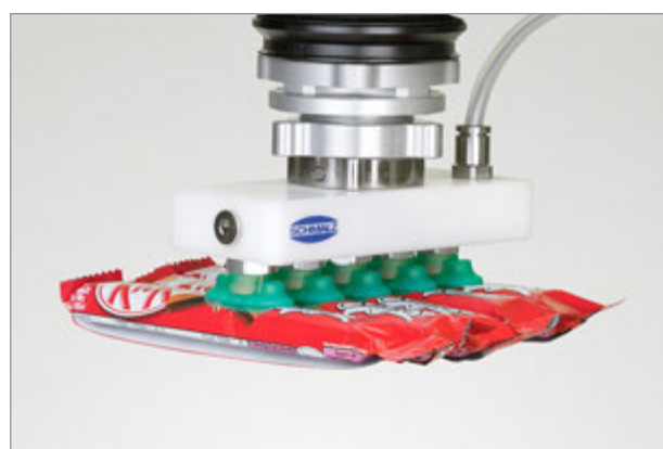
長円パッド SPOB1f によるピロー包装されたスナックバーの搬送
