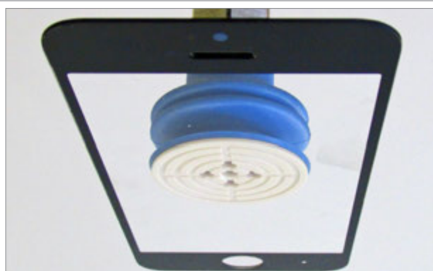
スマートフォンのディスプレイガラスの搬送に使用されるSPI-PEEK
