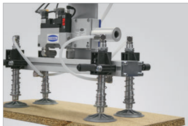
SEM-Cを使用した通気性の高いパーティクルボードの搬送
