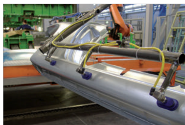
真空パッド SAOB によるカーブした車体部品の搬送
