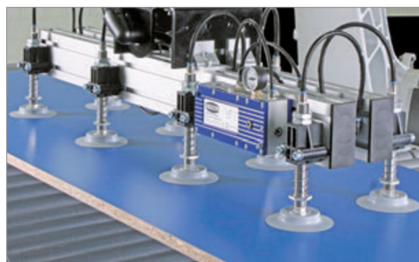
塗装済み合板の搬送に使用される大型真空パッド SPU
