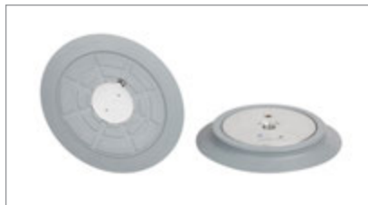
SPU-AE (二枚取り防止用インサート付き): 薄鋼板(約1.0~2.5 mm)の搬送時、薄鋼板の密着による二枚取りを防止します。
