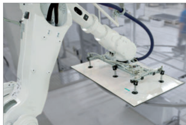
フラットパッドQNによる大判のプラスチック板の搬送
