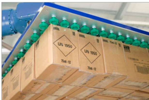
耐摩耗性・柔軟性に優れ、段ボール・鋼板・ガラス等に適したパッド
