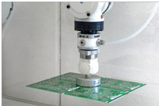
高通気性ワークやデリケートなワークに適した非接触パッド
