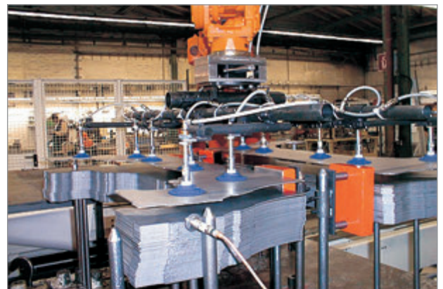
高さ補正や衝撃緩和に適したスプリングプランジャー FSTE-HD
