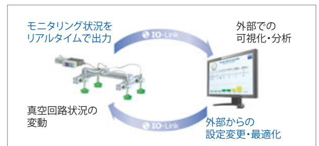
IO-Linkによる遠隔でのデータの可視化と最適化
