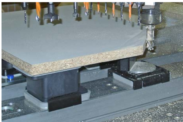
360度回転タイプの真空クランプブロックを使用した角部分の切削
