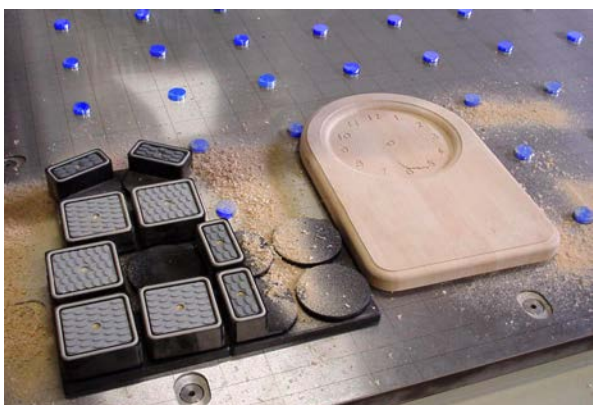
真空カップを自在に配置でき、複雑な形状の加工に最適
