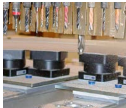
モノベースと高さ調整用リングを 使用した木板の固定
