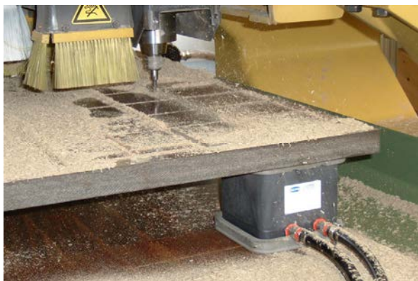
フラットテーブルに直接設置可能な真空クランプブロックVCBL-Gによる固定
