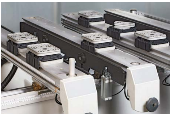
コンソール上に設置される真空クランプブロック (VCBL-K1-140x115x50、VCBL-K1-125x75x50-D-360)
