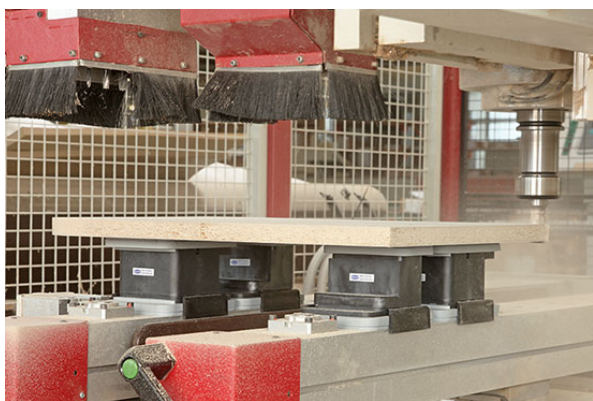
コンソール上に様々なブロックを配置し、任意の加工が可能
