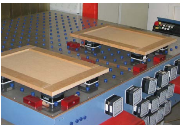
不要な真空口はマグネットプラグで塞ぎ、真空回路を構築
