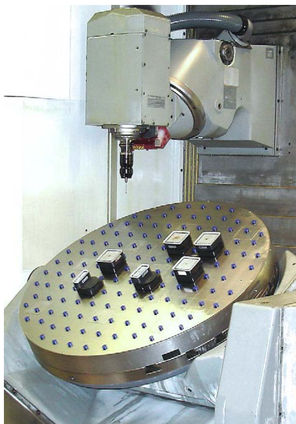
底面吸着のため回転式テーブルでの使用やワーク側面の加工に最適
