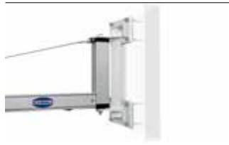
アンカーセット ・ブラケットを固定するベースプレートを鉄筋コンクリート壁に取り付ける際に使用する接着系あと施工アンカーのセット(必要最小壁厚200 mm) ・110 kgまでの荷重に対応(ジブの長さによって変動)
