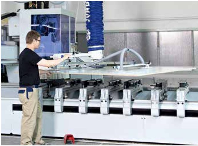
NCレーターへ材料の投入作業を行う真空バランサー「ジャンボエルゴ」
