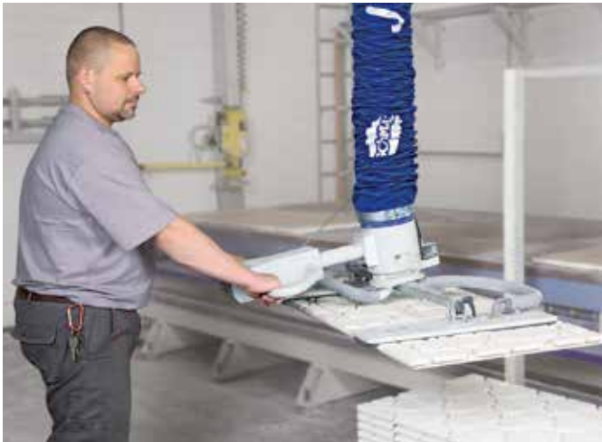
建材 | 穴、溝、隙間のあるワークの吸着が可能な、スポンジタイプの真空グリッパーを使用した真空バランサー「ジャンボエルゴ」
