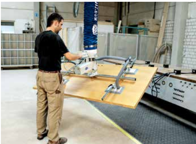
NCレーターに木板をセットする90°スイベル機能が搭載された真空バランサー「ジャンボエルゴ」
