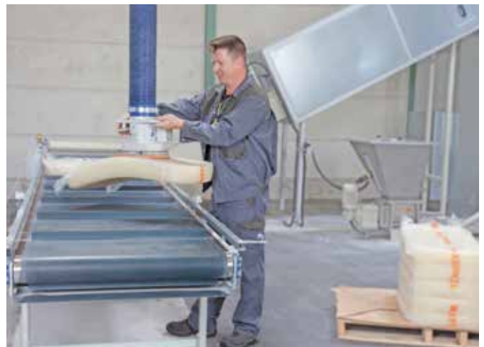
ゴム原料切断の工程にてゴムペールの搬送に使用される真空バランサー「ジャンボスプリント」
