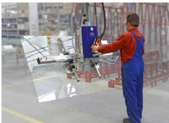
ガラス板を90°傾けて搬送を行うバキュームリフト「バキュマスターベーシック」
