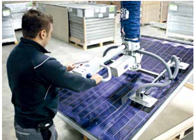
太陽光発電 | ソーラーパネルを取り扱う90°スイベル機能搭載の真空バランサー「ジャンボエルゴ」
