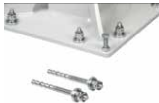
アンカーセット ・鉄筋コンクリートのスラブ用接着系あと施工アンカーのセット(必要最小肉厚200 mm) ・追加の基礎工事は不要 ・1,000 kgまでの荷重に対応可能
