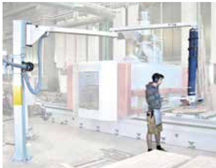
関節式ジブクレーン 障害物を避けて移動することが可能なジブクレーン
