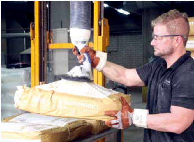
クラフト紙袋のパレタイジングに使用される真空バランサー「ジャンボフレックス」
