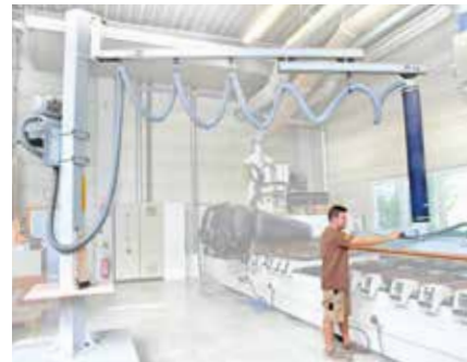
伸縮式ジブクレーン 限られた作業エリアでの利用に適したジブクレーン
