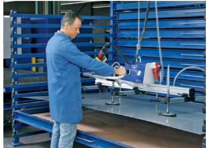
鉄板を水平搬送でラックに収納するバキュームリフト「バキュマスターベーシック」
