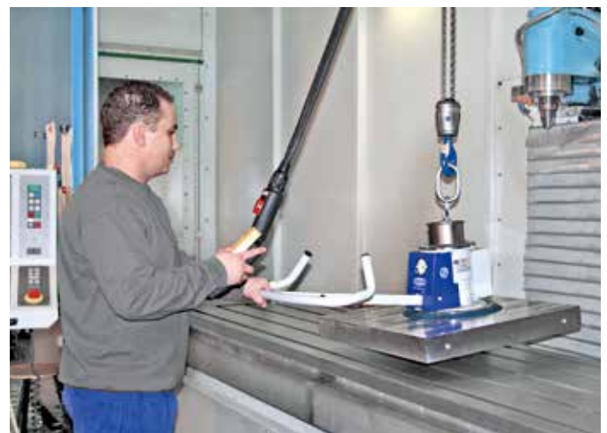
電気やエアのエネルギー供給を使用せず、金属部品の搬送を行うバキュームリフト「バキュマスターエコ」
