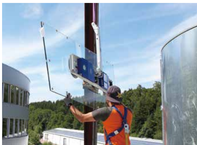
屋外にてガラス板の安全搬送のため使用されるバキュームリフト「バキュマスターガラス」
