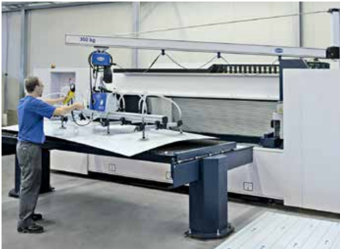
レーザー加工機への投入を行うバキュームリフト「バキュマスターベーシック」
