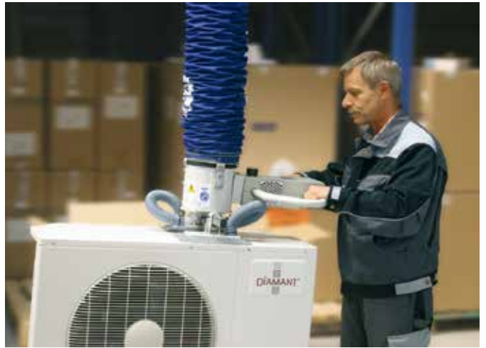
家電製品 | 室外機を搬送する2連吸着パッドを装着した真空バランサー「ジャンボエルゴ」
