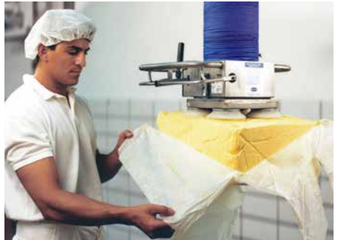
食品を吸着することが可能なシリコーンゴム製のパッドを装着した真空バランサー「ジャンボスプリント」
