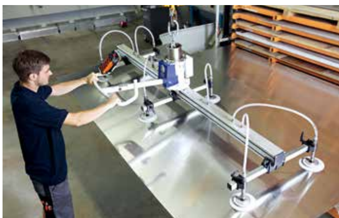
ラックから薄鋼板を取り出す作業
