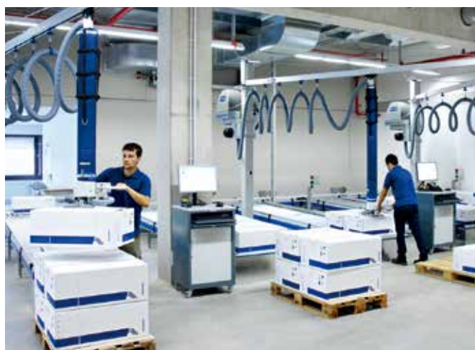
段ボール箱をパレタイズする真空バランサー「ジャンボエルゴ」
