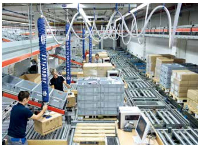
入出荷時の荷物を素早く搬送する真空バランサー「ジャンボフレックス」
