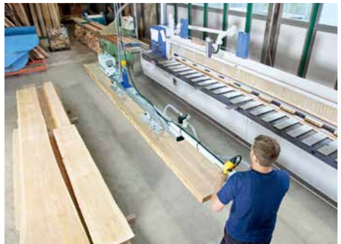
長尺材を横から操作して加工機に投入するバキュームリフト「バキュマスター」
