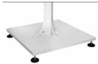
移動用ベースプレート ・アンカー等での設置取付工事は不要 ・フォークリフト等で移動でき使用場所の変更が容易 ・荷重に合わせたサイズラインナップ(□1,200 mm ~ 1,470 mm) ・200 kgまでの荷重に対応(ジブの長さによって変動あり)
