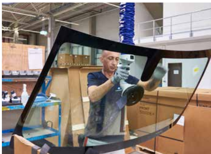
フロントガラスを搬送する真空バルンサー「ジャンボフレックス」
