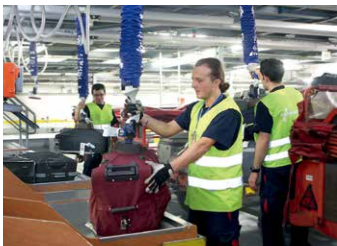
空港で様々な種類の手荷物を取り扱う、真空吸着パッドとサスペンションが一体化したグリッパーを装着した真空バランサー「ジャンボフレックス」
