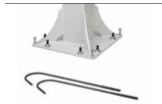
アンカーボルト ・新たにコンクリート基礎工事を行う場合に使用 ・基礎の寸法(□1,300 mm ~ 2,300 mm)に合わせたラインナップ ・1,000 kgまでの荷重に対応可能
