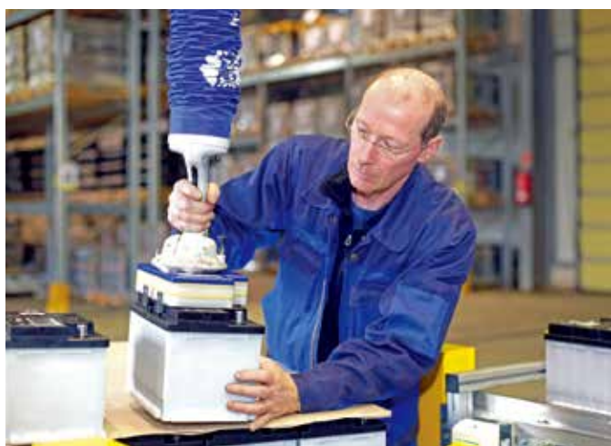
カーバッテリーを搬送する真空バルンサー「ジャンボフレックス」
