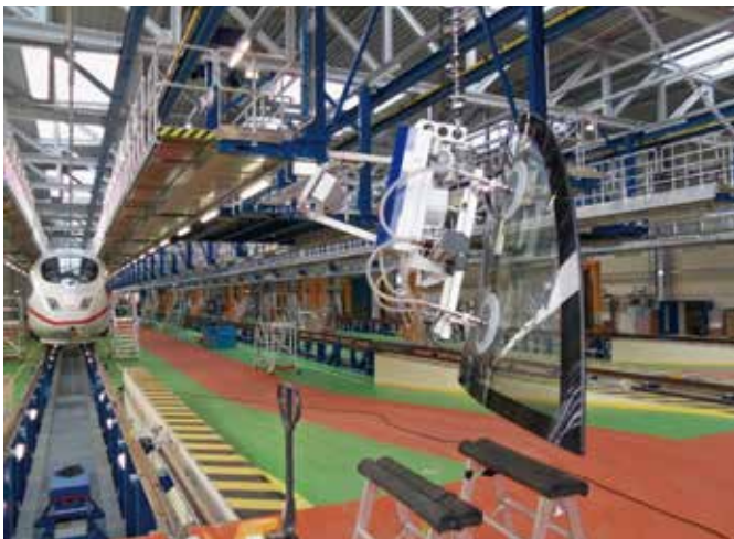
鉄道・航空機 | 鉄道車両工場で窓を搬送する90°スイベル機能搭載のバキュームリフト「バキューマスターコンフォート」
