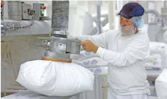
防爆エリアで化学薬品や農業肥料などの袋を取り扱う防爆対応の真空バランサー「ジャンボスプリント EX」
