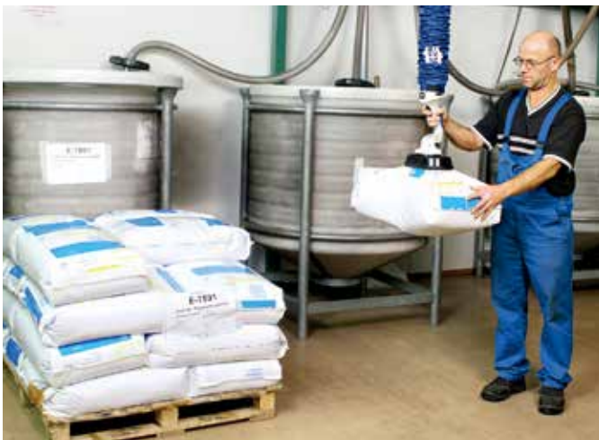
プラスチック製の袋をパレタイズするために使用される真空バランサー「ジャンボフレックス」
