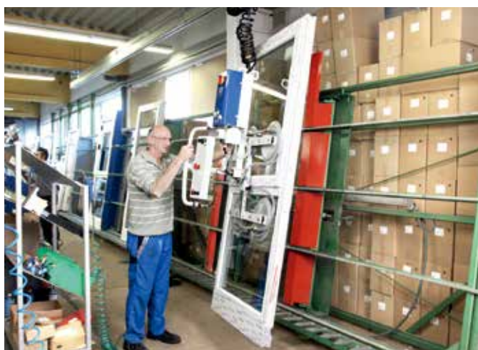
仕切りのある窓用複層ガラスの垂直搬送を行うバキュームリフト「バキュマスターウィンドウコンフォート」
