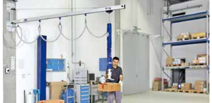
壁付けジブクレーン (WKタイプ) と真空バランスー「ジャンボ」の組合せ
