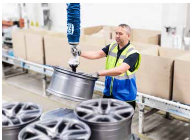
ホイールを搬送して梱包を行う真空バルンサー「ジャンボフレックス」
