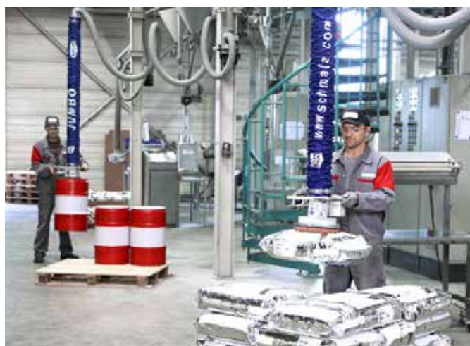
袋やドラム缶をパレタイズする真空バランサー「ジャンボスプリント」
