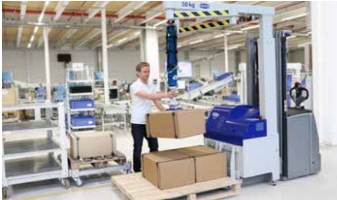
倉庫内でのピッキング作業を行う移動式真空バルンサー「ジャンボフレックスピッカー」
