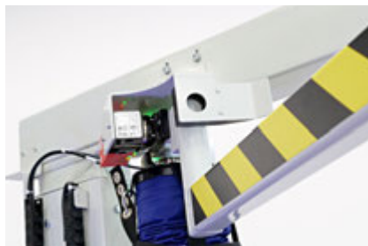
移動中にジブを安全な位置に固定し、コンパクトに収納する電磁ロック機構。
