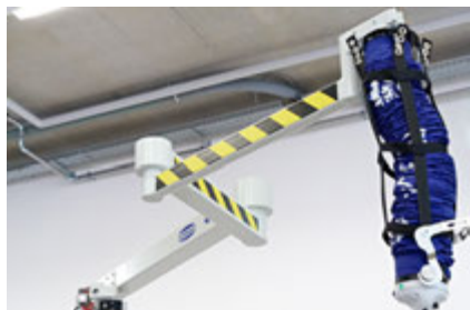
2連式のアルミ製関節式ジブクレーンは360°自在に回転し、広範囲での作業を実現。
