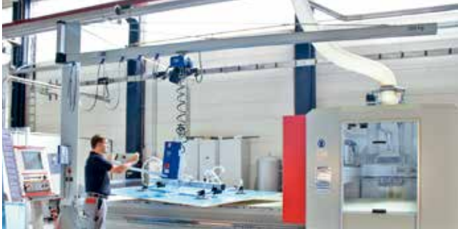
柱付けジブクレーン (SKタイプ) に、電気チェーンブロックとバキュームリフト「バキュマスター」の組合せ
