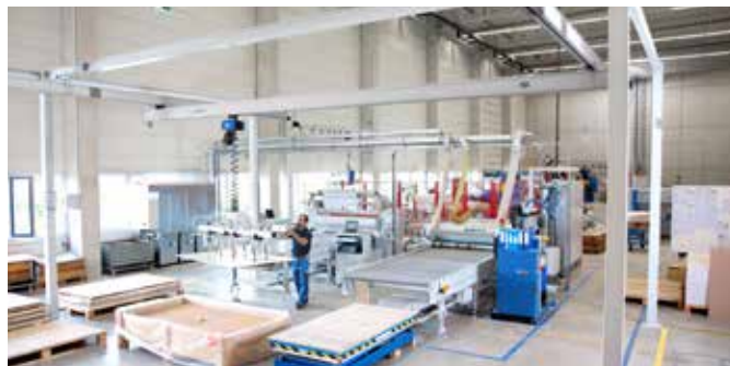
電気チェーンブロックとバキュームリフト「バキュマスター」を備えたやぐら型のクレーンシステム
