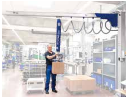
フラットジブクレーン 天井が低い場合に効果的なジブクレーン
