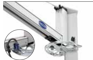
旋回角度ストッパー ・ ジブの旋回範囲を制限するストッパー ・ 両方向0 ~ 100°までの旋回角度の調整が可能 ・ ジブの位置を検出可能なセンサを追加可能 (オプション)
