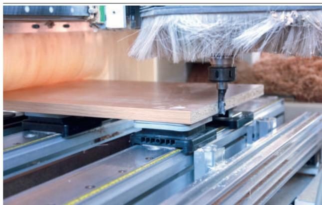
Blocs de bridage par le vide VCBL-S utilisé sur des consoles SCM
