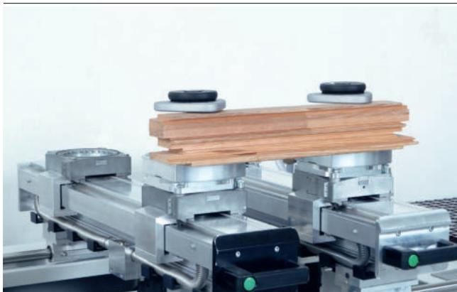
Bloc de serrage VCMC-B-QUICK serrage d'éléments de cadre
