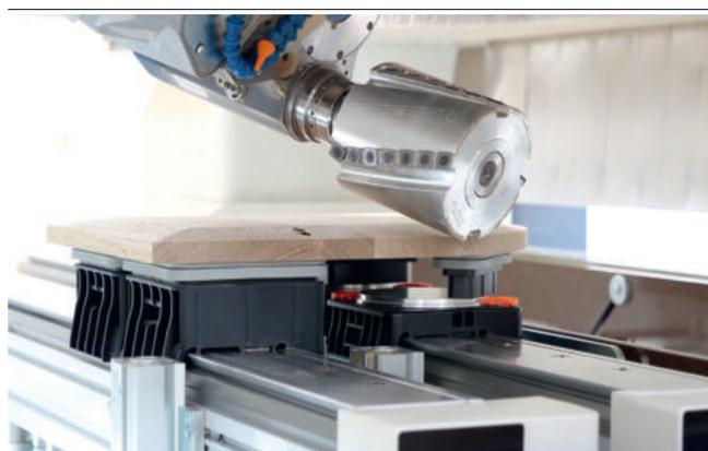
Blocs de bridage par le vide VCBL-S6 utilisé sur des profils SCM
