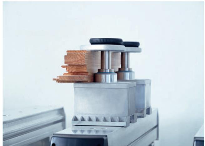
Bloc de serrage VCMC-K1 lors de l'usinage d'éléments de cadre fins
