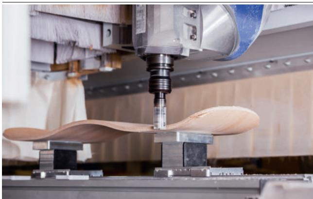
Blocs de bridage par le vide en aluminium VCBL-A-K2 pour le bridage de pièces en bois massif
