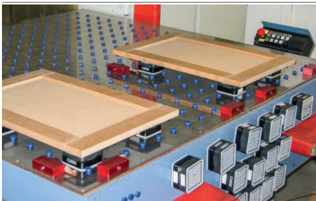
Innospann Steel-Plate avec Mono-Bases et blocs ventouses
