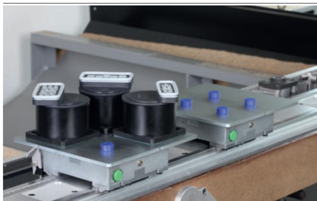
Plaques d'adaptation ISAP-B avec Mono-Base et blocs ventouses pour le bridage de pièces en bois
