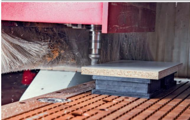
Bloc de bridage par le vide VCBL-R pour le bridage d'un panneau d'aggloméré
