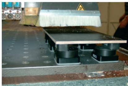
Innospann Plaque métallique montée sur une table lisse
