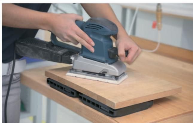
Multi-Clamp plaque de bridage VC-M-SP pour l'usinage manuel d'une pièce en bois
