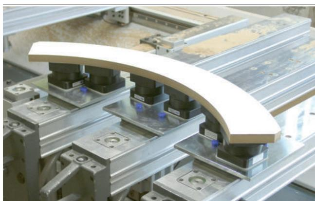
Plaques d'adaptation ISAP-K2 avec Mono-Bases et blocs ventouses pour le bridage de pièces en bois
