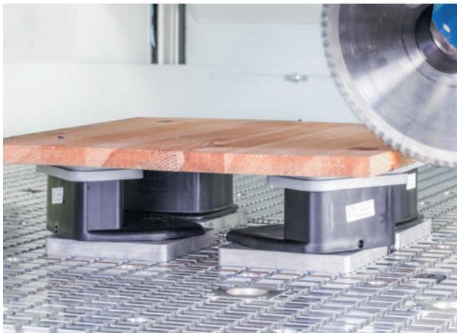
Plaques d'adaptation AP-R avec blocs de bridage par le vide VCBL-B lors du bridage de pièces en bois
