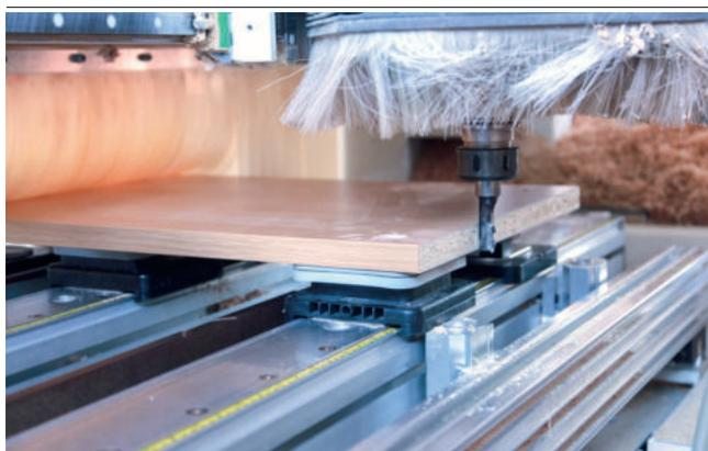
Blocs de bridage par le vide VCBL-S4 utilisé sur des consoles SCM
