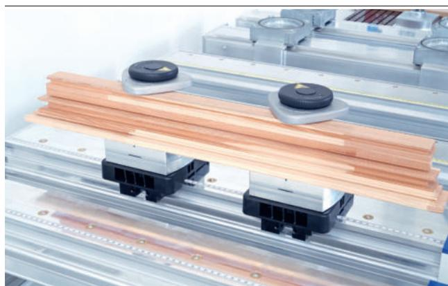
Bloc de serrage VCMC-S6-QUICK serrage d'éléments de cadre
