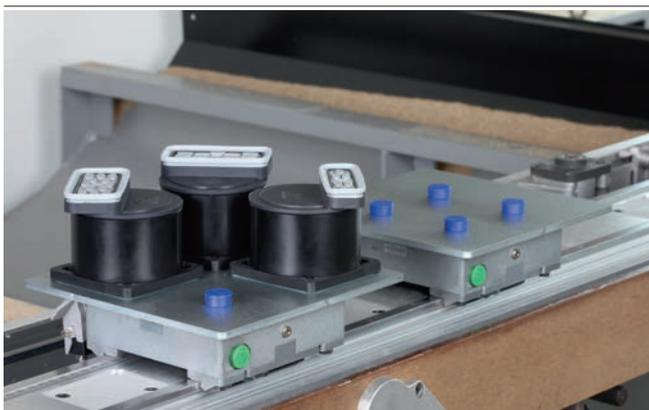
Adapter-Plates ISAP-B mit Mono-Bases und Sauger-Cups zum Aufspannen von Holzbauteilen
