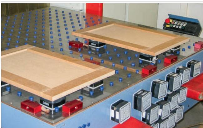
Innospann Steel-Plate mit Mono-Bases und Sauger-Cups
