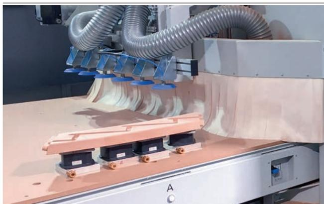
Adapter-Plates AP-G mit Blocksauger VCBL-B beim Aufspannen eines Holzwerkstücks
