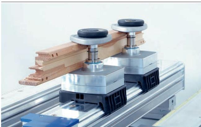
Mechanische Spanner VCMC-S4-QUICK beim Aufspannen von Rahmenteilen
