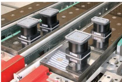
Innospann Steel-Plate-T montiert auf einem Konsolentisch
