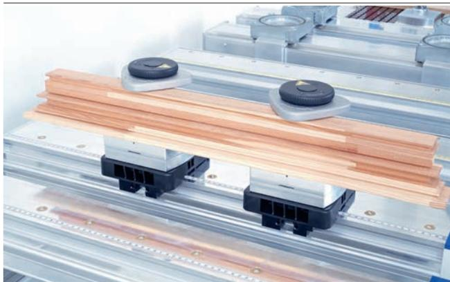
Mechanische Spanner VCMC-S6-QUICK beim Aufspannen von Rahmenteilen
