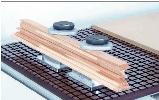
Mechanischer Spanner VCMC-R-QUICK beim Aufspannen von Rahmenteil
