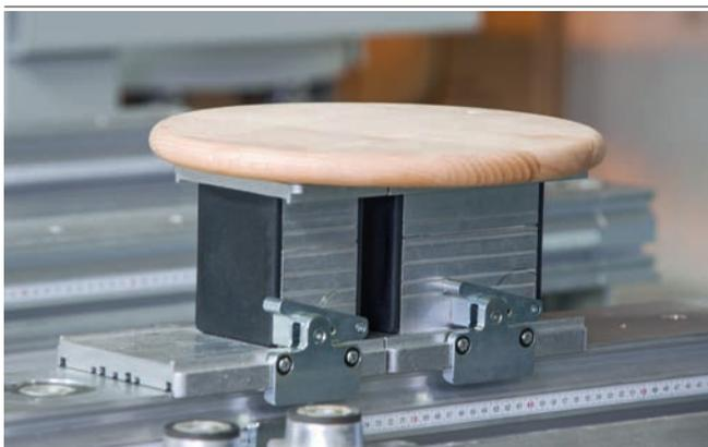
Aluminium-Blocksauger VCBL-A-K1 beim Aufspannen von Massivholz
