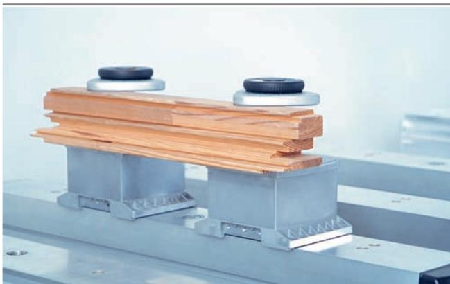
Mechanischer Spanner VCMC-K2-QUICK beim Aufspannen von Rahmenteilen
