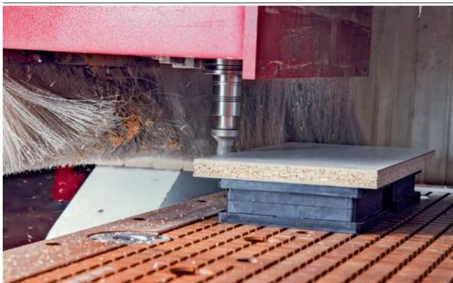
Blocksauger VCBL-R beim Aufspannen einer Spanplatte
