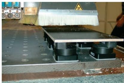
Innospann Steel-Plate-T montiert auf einem Glatttisch
