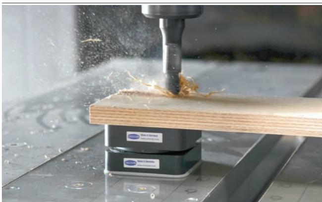
Innospann Cup und Mono-Base beim Aufspannen eines Holzwerkstücks
