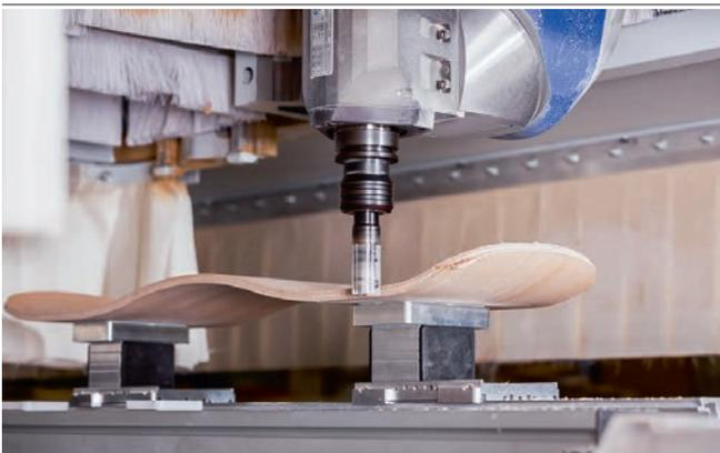
Aluminium-Blocksauger VCBL-A-K2 beim Aufspannen von Massivholz
