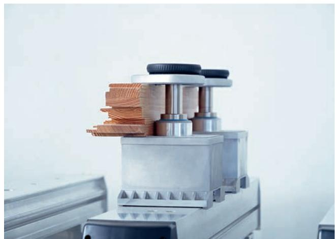
Mechanische Spanner VCMC-K1-QUICK beim Aufspannen von Rahmenteilen
