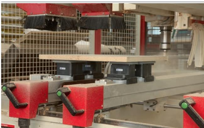
Blocksauger VCBL-K2 beim Aufspannen eines Werkstücks
