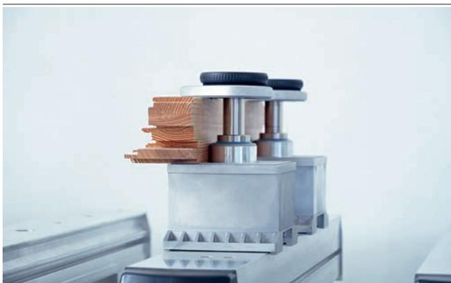
Mechanische Spanner VCMC-K1-QUICK beim Aufspannen von Rahmenteilen
