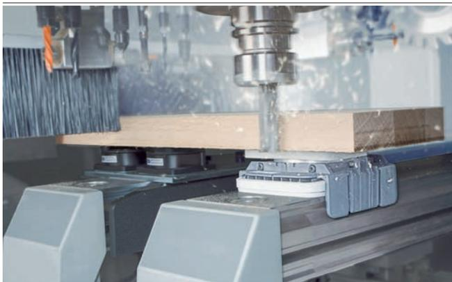
Blocksauger VCBL-K1 beim Aufspannen von Massivholz
