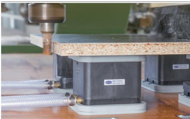
Blocksauger VCBL-G-K2 beim Aufspannen einer Spanplatte
