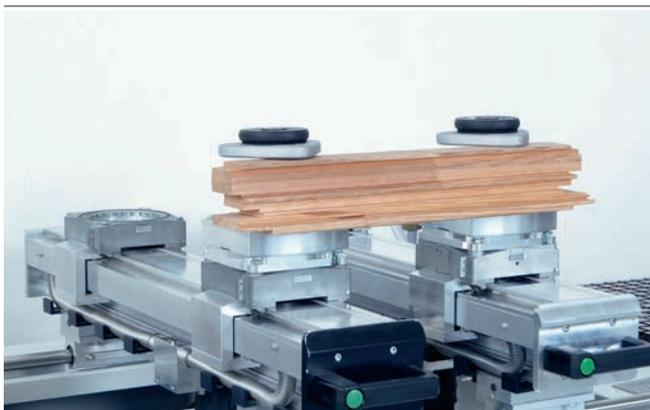
Mechanischer Spanner VCMC-B-QUICK beim Aufspannen von Rahmenteilen
