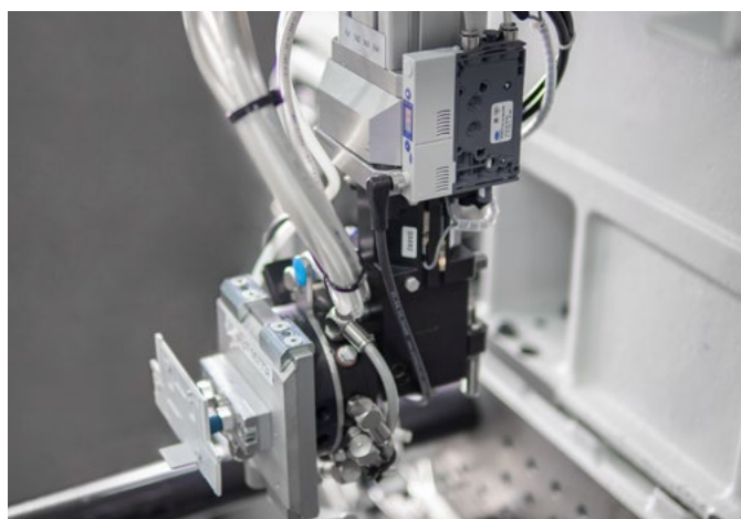
Kompaktejektor SCPMc bei der Entnahme von Kunststoffspritzgussteilen
