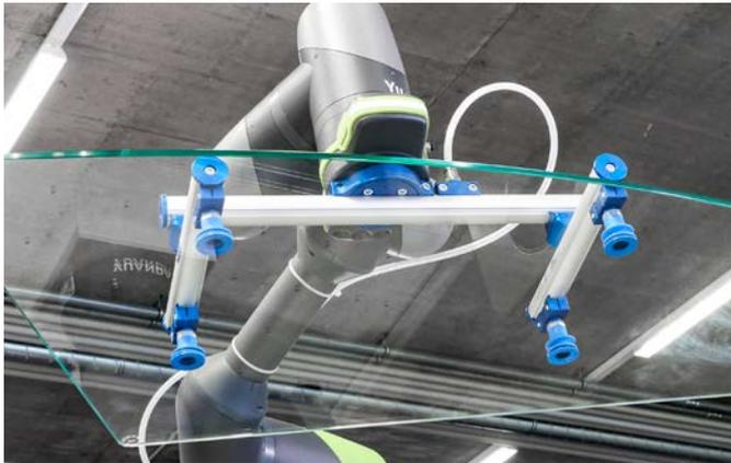
Modularer PXT-Greifer bei der Handhabung einer Glasscheibe
