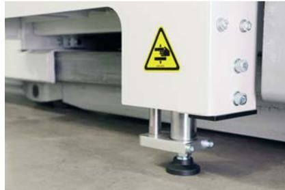
Die Stützfüße fahren nach dem Entriegeln des Auslegers automatisch aus, wodurch Taktzeiten minimiert werden.
