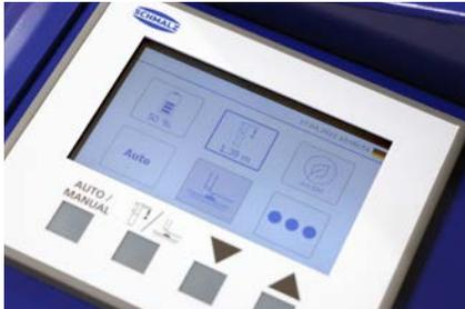
Das übersichtliche Touch-Display mit Soft-Tasten ermöglicht eine einfache und intuitive Bedienung.
