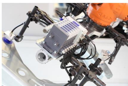
Schmalz bietet sein Kompaktterminal SCTSi sowie den elektrischen Vakuum-Erzeuger ECBPMi zukünftig auch in Varianten mit IO-Link Wireless an.
