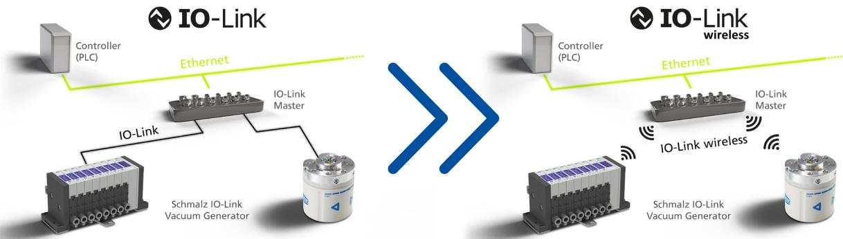
Mit IO-Link Wireless optimieren Sie kabelgebundene Systeme durch eine flexible Funklösung – für maximale Bewegungsfreiheit, schnelle Inbetriebnahme und zuverlässige Kommunikation selbst in dynamischen Anwendungen.
