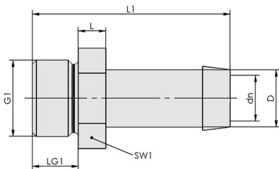
Dati di costruzione ST G3/4-AG 13 MS-V
