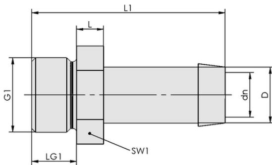
Datos de diseño ST G3/8-AG 13 MS-V
