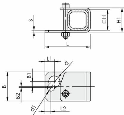
Dati di costruzione HTR-ST5 30x30 D10/16 WI
