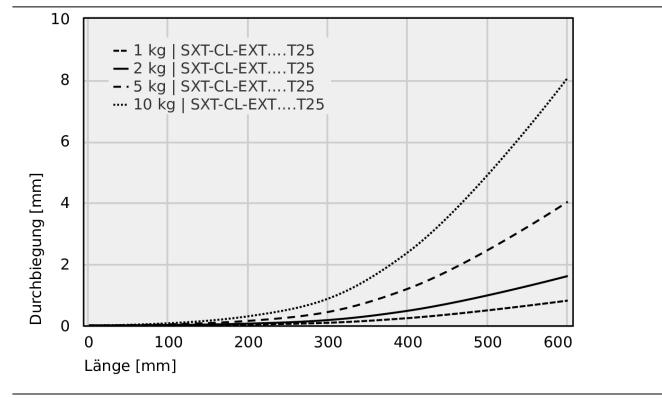
Durchbiegung Rohr 25 x 3 mm
