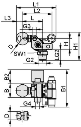
Dati di costruzione HT-SG A3 I 10 31 NPT3/8-AG AB
