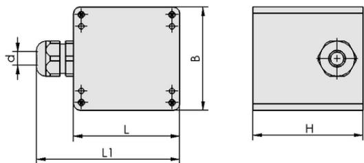
Konstruktionsdaten WN-E AKUST -1...0 AC
