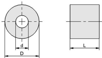
Dati di costruzione FILT-EINS 15 27x23 A2 VF-1/4-Draht
