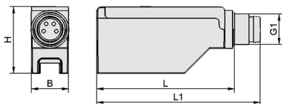
Datos de diseño VS-V-AH-T-PNP M8-4
