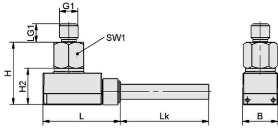
Datos de diseño VS-V-SD 60 M3-AG
