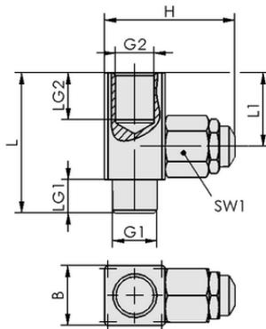
Konstruktionsdaten DBV-M G1/4-AG MS
