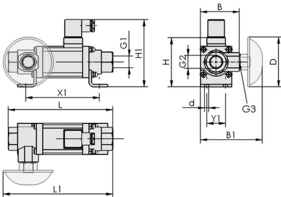
Konstruktionsdaten EMV 10 24V-DC 3/2 NO
