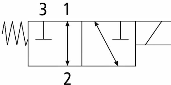
Schaltdiagramm EMV 10 24V-DC 3/2 NO
