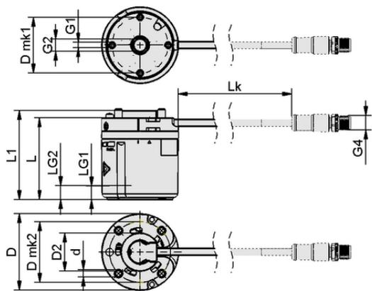
Dati di costruzione ECBPMi 24V-DC M12-8
