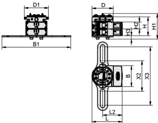
Konstruktionsdaten RECBi 24V-DC NO PXR-I 2C MATCH
