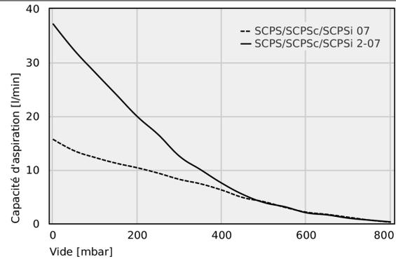
Capacité d'aspiration à différents degrés d'évacuation [l/min]
