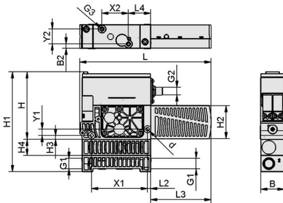
Dati di costruzione SXPi 25 NC H M12-8
