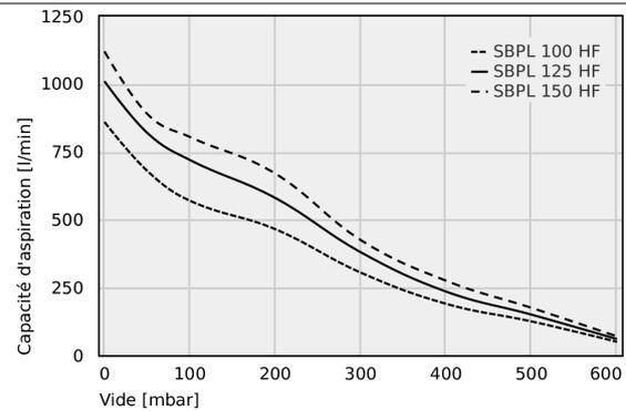
Capacité d'aspiration à différents degrés d'évacuation [l/min]
