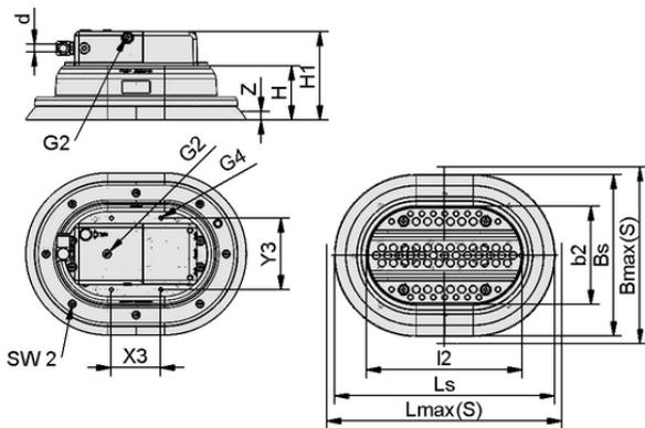
Dati di costruzione PSSG X 290x215 NBR-60 M6-IG
