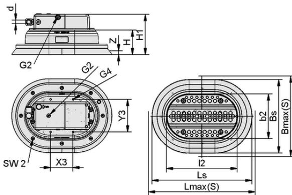
Données de construction PSSG X 290x215 NBR-60 M6-IG
