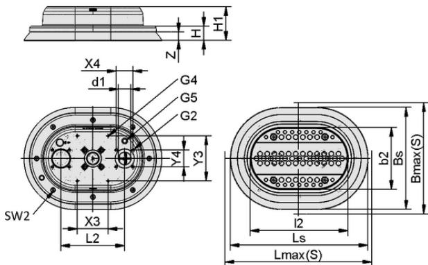
Konstruktionsdaten PSSG M 350x250 SI-55 M6-IG
