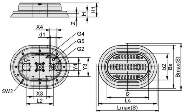
Dati di costruzione PSSG M 350x250 NBR-60 M6-IG
