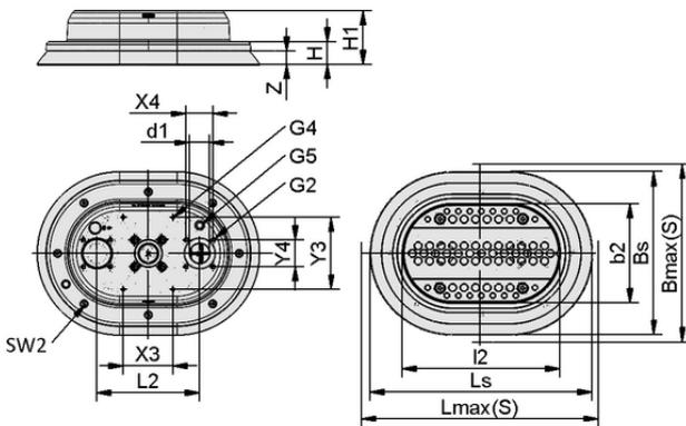
Datos de diseño PSSG M 350x250 NBR-60 M6-IG
