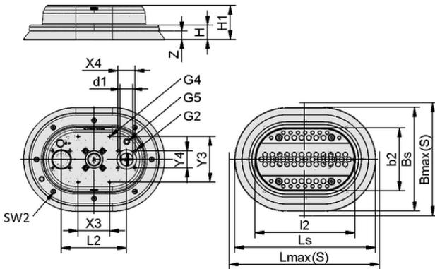
Datos de diseño PSSG M 290x215 NBR-60 M6-IG
