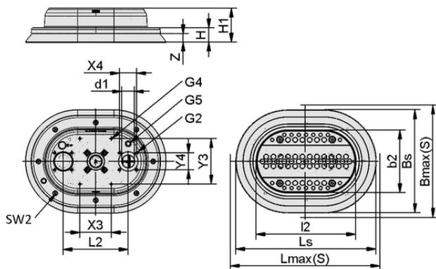
Données de construction PSSG M 405x305 NBR-60 M6-IG
