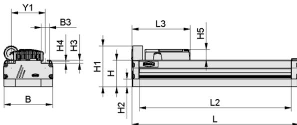
Dati di costruzione FXP-SW70 442 3R18 O10O10 F
