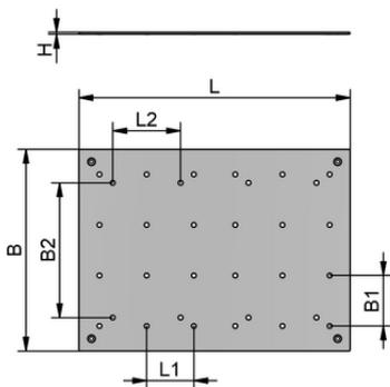
Konstruktionsdaten ISST-MPL 600x400x3 SFM
