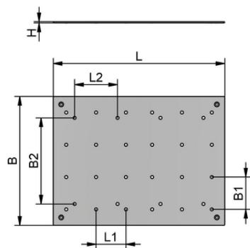
Konstruktionsdaten ISST-MPL 400x300x3 SFM
