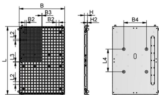
Dati di costruzione MPL 300x200x28 12,5x12,5 3x3
