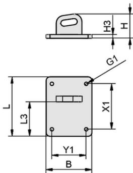
Dati di costruzione MOD-FLAN 157x120 SBX-C
