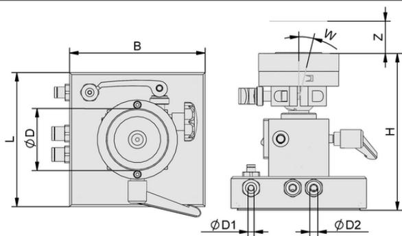
Dati di costruzione UB 135x135x156 29.5 15 G
