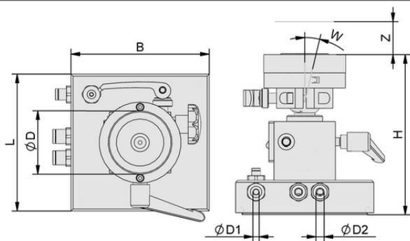
Dati di costruzione UB 135x135x156 29.5 15 ISST
