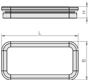
Données de construction ISDR 81x43x12 Cup 2 NBR-50
