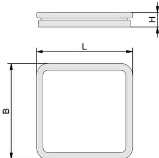
Dati di costruzione ISDR 167x167x9.3 NBR-55
