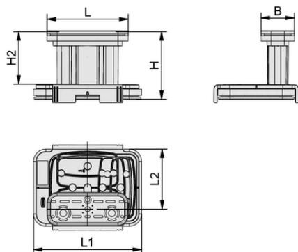
Dati di costruzione VCBL-K2-PRO 125x75x100 L
