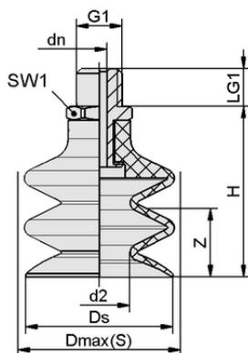
Dati di costruzione FSG 9 SI-MD-55 M5-AG
