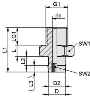
Dati di costruzione SA-NIP N062 M5-AG DN250
