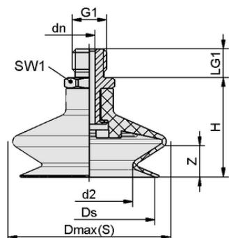
Dati di costruzione FSGA 16 NBR-ESD-55 M5-AG
