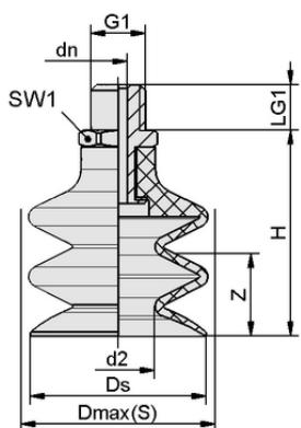
Données de construction FSG 9 NBR-ESD-55 M5-AG
